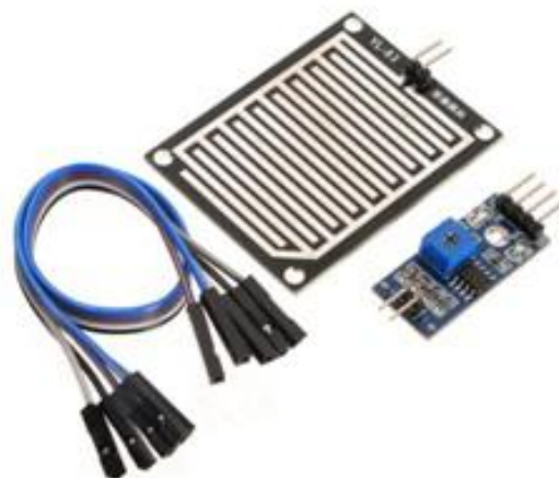
Figura 2: Sensor de Chuva YL-83 e Placa de Controle
